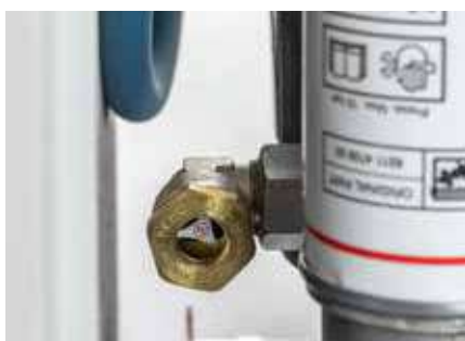
/// Controllo del livello dell'olio Oil level check
